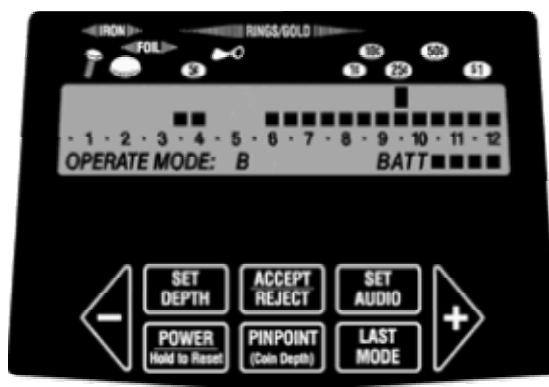
**Power (Электропитание):** Включает/выключает питание металлодетектора, выполняет сброс на установки завода-изготовителя.
