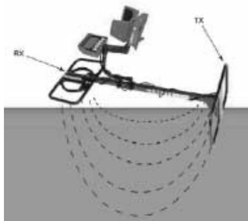
Приставка мультипликатор глубины **Depth Multiplier** делает ненужным применение «двухкорпусного» металлодетектора и увеличивает глубину обнаружения, на которой детектор способен обнаруживать предметы крупнее, чем банка фруктовых консервов. Умножитель глубины позволяет обнаруживать более крупные предметы на больших глубинах и не подвержен влиянию помех от мелкого металлического мусора, что сводит к минимуму ненужные раскопки.
